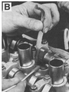
Rys. 1.1. Wymiana płytek regulacji luzu zaworów
