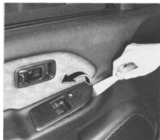
Rys. 12.19. Wymywanie z drzwi przednich płytki przełącznikowe elektrycznego sterowania szyby
