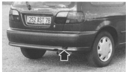
Rys. 0.8. Tylny zaczep do holowania samochodu
