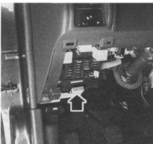
Rys. 2.21. Usytuowanie złącza diagnostycznego
