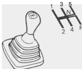
Rys. 0.17. Schemat zmiany biegów skrzynki mechanicznej
