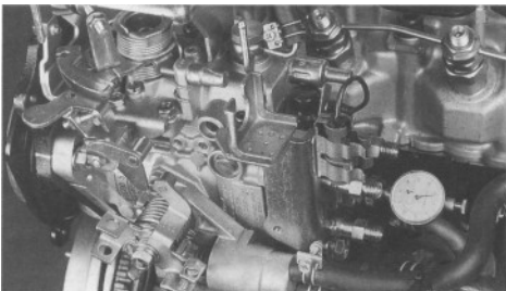
Rys. 2.11. Ustawianie pompy wtryskowej z pomocą komparatora wyposażonego w specjalną końcówkę (przyrząd KV11229350)
