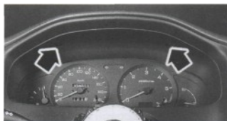
Rys. 11.12. Rozmieszczenie śrub mocujących ramkę zestawu wskaźników
