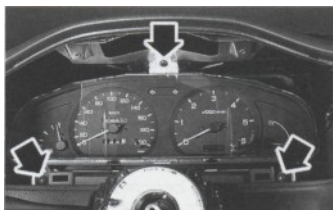
Rys. 11.13. Rozmieszczenie śrub mocujących obudowę zestawu wskaźników
