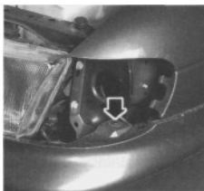
Rys. 12.6. Usytuowanie zaczepu bocznego mocowania zderzaka przedniego
