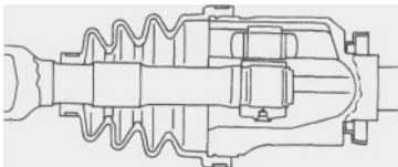
Rys. 6.5. Przekrój przegubu trójramiennego TS70C oraz TS79C
