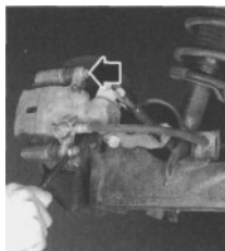
Rys. 70.9. Odkręcanie śrub prowadników zacisku hamulca tylnego
