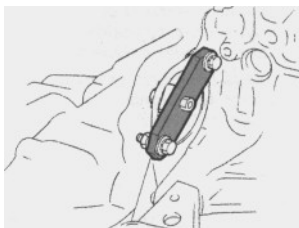
Rys. 2.26. Unieruchomienie koła zamachowego za pomocą przyrządu KV10105630 zamontowanego zamiast rozrusznika
