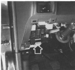
Rys. 1.6. Usytuowanie złącza diagnostycznego
