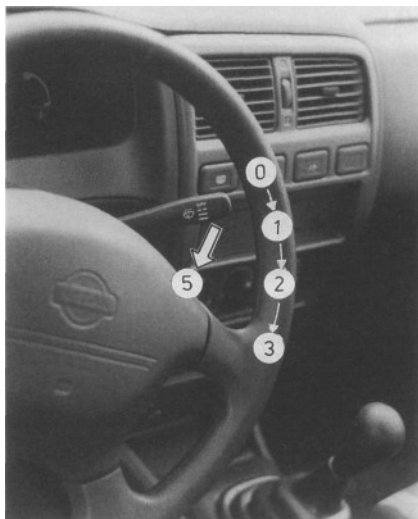
Rys. 0.35. Położenia dźwigni przełącznika wycieraczki i spryskiwacza szyby przedniej
