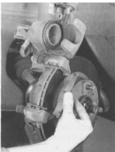
Rys. 10.3. Wymywanie wkładek ciernych po obróceniu zacisku hamulca przedniego
