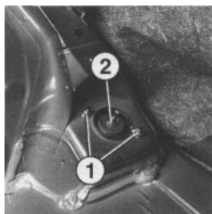
Rys. 9.7. Elementy górnego mocowania kolumny resorującej
