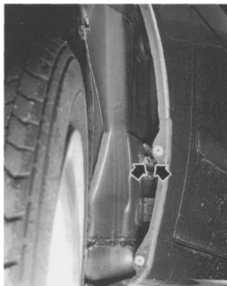
Rys. 12.14. Rozmieszczenie śrub mocowania zawiasu drzwi do nadwozia
