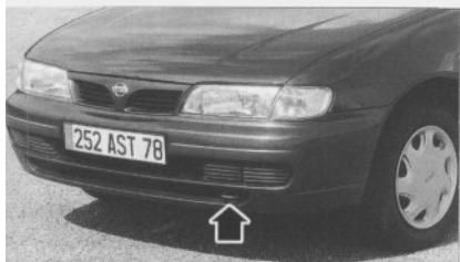
Rys. 0.7. Przednie zaczepy do mocowania (rys. górny) i przedni zaczep do holowania samochodu (rys. dolny)
