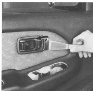
Rys. 12.20. Wymywanie osłony klamki wewnętrznej drzwi przednich
