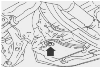
Rys. 5.5. Usytuowanie korka spustu oleju automatycznej skrzynki przekładniowej
