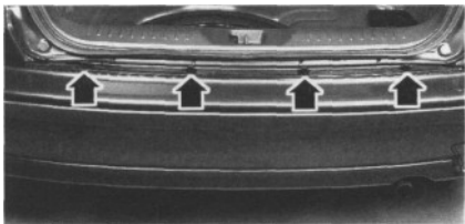
Rys. 12.36. Rozmieszczenie górnych elementów mocowania zderzaka tylnego
