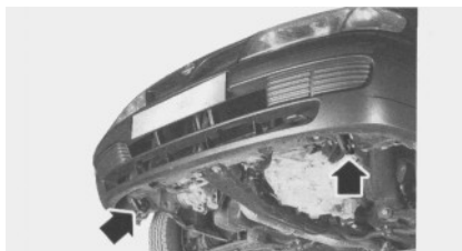
Rys. 0.6. Miejsca do podnoszenia samochodu (opis w tekście)
