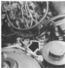
Rys. 2.58. Usytuowanie odpowietrznika układu chłodzenia
