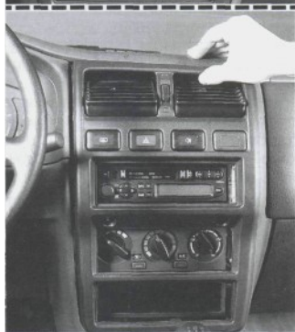
Rys. 11.22. Wymontowanie płyty środkowej tablicy rozdzielczej 1 — śruby mocujące płytę środkową, 2 — zatrzaski mocujące płytę środkową
